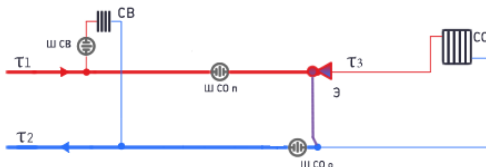
Рисунок 3 – Схема подключения потребителей к двухтрубной тепловой сети (при наличии внутренней системы отопления), в качестве регулятора температуры используется элеватор (СО – система отопления, Э – элеватор, СВ – система вентиляции)
